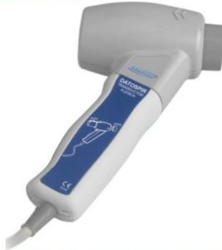
El transductor diferencial recoge la presión antes de la resistencia ( $P_1$ ) y después de la resistencia ( $P_2$ ) para calcular el flujo; por integración de este último se obtiene el volumen.
