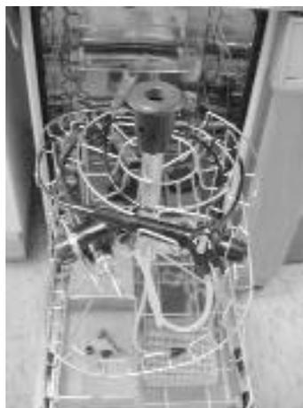
**Figura 2.** Desinfección automática: colocación del broncofibroscopio y válvulas en la máquina lavadora.
